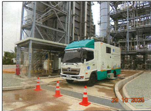
ภาพที่ 1 แสดงการตรวจวัดเพื่อทดสอบความแม่นยำสัมพัทธ์ ระบบ CEMS สำหรับตรวจวัดก๊าซ ของปล่องหน่วยผลิตไอน้ำ HRSG# 51
