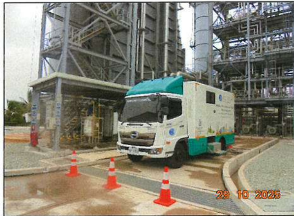
ภาพที่ 3 แสดงการตรวจวัดเพื่อทดสอบความแม่นยำสัมพัทธ์ ระบบ CEMS สำหรับตรวจวัดก๊าซ ของปล่องหน่วยผลิตไอน้ำ HRSG# 52
