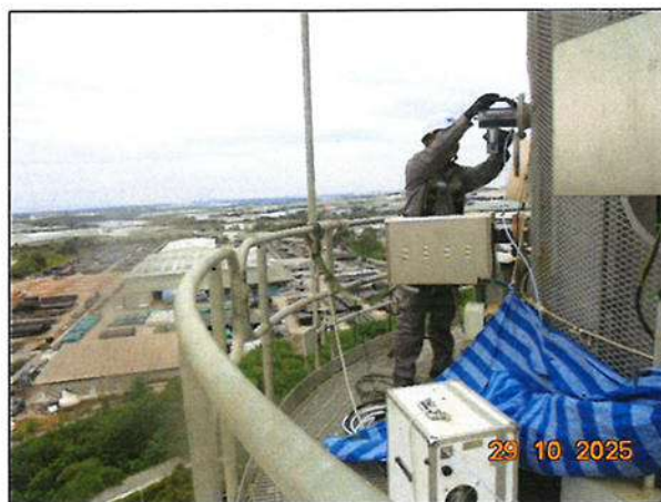
ภาพที่ 4 แสดงการตรวจวัด RM Method ของปล่องหน่วยผลิตไอน้ำ HRSG# 52
