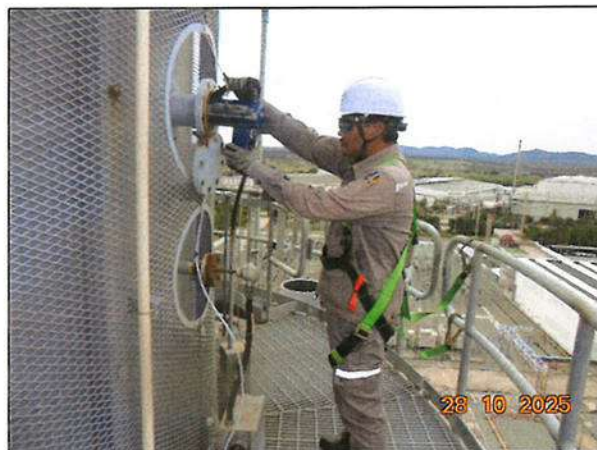
ภาพที่ 2 แสดงการตรวจวัด RM Method ของปล่องหน่วยผลิตไอน้ำ HRSG# 51
